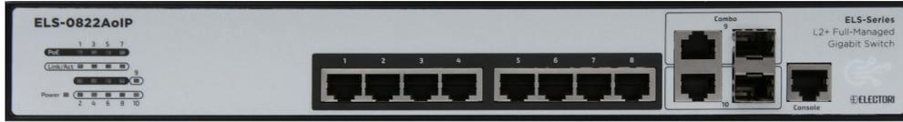
ELS-0822AoIP は、Dante™ をはじめとするオーディオネットワークでの運用に最適化された、音響設備用のネットワークスイッチです。L2+ のフルマネージメント機能を搭載し、アップリンクポートとして SFP スロットを 2 ポート搭載。MONISMS 製の AoIP、PoE+ (30W) スピーカーにマッチした最大 210W の給電に対応しており同時に 7 台まで稼働可能。更に、ホールなどの袖に設置しても静粛性を保つことが可能なファンレス設計になっています。
