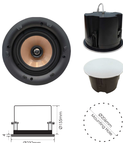
スピーカーグリルはマグネットで固定されます。 底面のネジ4本を回すことで天井ボードに挟み込まれ固定されます。
