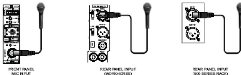
コンデンサーマイクをお使いになる場合、ファントム電源をオンにする必要があります。ダイナミックマイク、リボンマイクではファントム電源は不要です。ファントム電源はオフにしておいてください。ファントム電源のスイッチは不意に押されてファントム電源がオンになることでリボンマイクを損傷することなどが無いよう窪んだ位置に搭載されています。
