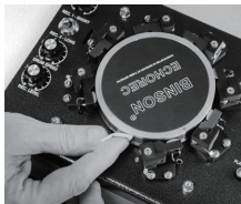
写真3：ドラムへの注油
