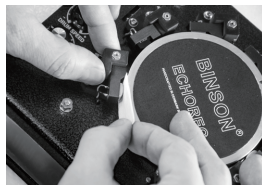
写真2：磁気ヘッドのクリーニング
