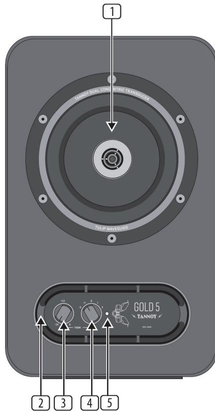
① **DUAL CONCENTRIC SPEAKER** : サウンドを出力するための同軸スピーカーです。
